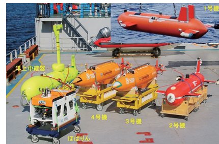
図3 AUV 及び洋上中継機の開発 (SIP-1 研究) (国立研究開発法人)海上・港湾・航空技術研究所 海上技術安全研究所 次世代海洋資源調査技術―海のジバング計画―
